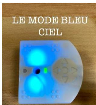
Le robot va tourner sur lui-même. Il est programmé pour tourner vers la droite. Si l'on trace sur une feuille des lignes noires épaisses, le robot va suivre automatiquement la trace.
