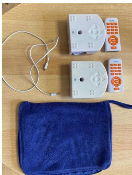
Il comprend différents capteurs qui peuvent mesurer la lumière, les distances, la température, etc. Il possède également des boutons tactiles, il peut se rendre compte qu'on lui donne une petite tape et peut entendre quelqu'un qui frappe dans ses mains. Il possède deux roues, chacune reliée à un moteur, lui permettant de se déplacer sur une table, ou sur le sol. Il peut également s'illuminer de toutes les couleurs et jouer de la musique !
